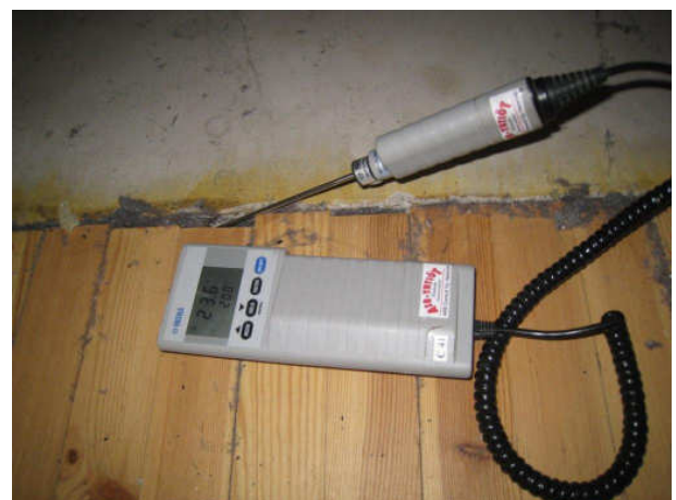
Kuva 24 Kosteusmittaus VTV5 salin ja tuolivaras- ton rajalta 24 %RH.
