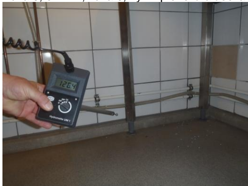
Kuva 7, keittiön nurkasta toiseen suuntaan lähtevällä seinäosuudella havaittiin keittiön puolella alimmassa laattarivissä KKA, muttei seinän ruokalan puolella kuva 8
