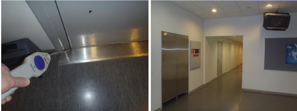
Kuva 9, merkkiainetta levisi koulun käytävälle epätiivistä lämmönjakohuoneen ovesta (ljh ylipaineinen kouluun nähden). Kuva 10, keittiön edessä oleva käytävä, ljh:n ovi näkyvissä. Kuvassa näkyy myös Linoleum taulu.
