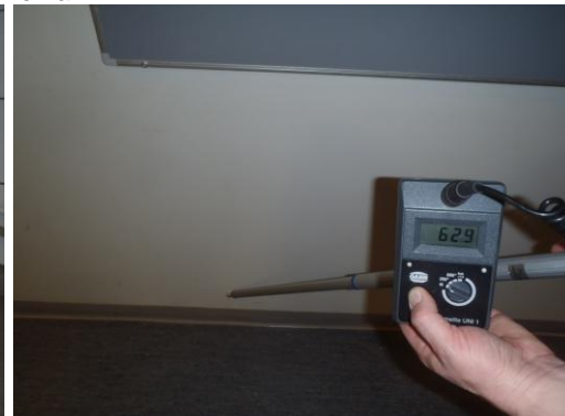
Kuva 7, keittiön nurkasta toiseen suuntaan lähtevällä seinäosuudella havaittiin keittiön puolella alimmassa laattarivissä KKA, muttei seinän ruokalan puolella kuva 8
