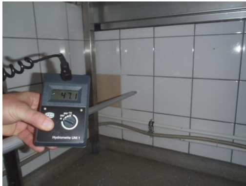
Kuvat 1 ja 2, pesulinjan nurkka, jossa aistittu poikkeavaa hajua. Keittiön puolella ei havaittu kohonneita kosteuden arvoja (KKA), mutta käytävän puolella pienellä alueella. Tiskin ja seinän rako on tiivistetty.
