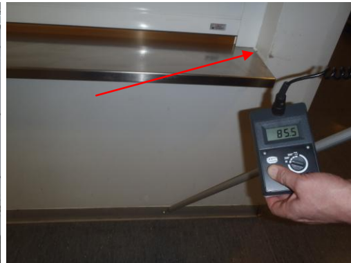
Kuvat 1 ja 2, pesulinjan nurkka, jossa aistittu poikkeavaa hajua. Keittiön puolella ei havaittu kohonneita kosteuden arvoja (KKA), mutta käytävän puolella pienellä alueella. Tiskin ja seinän rako on tiivistetty.
