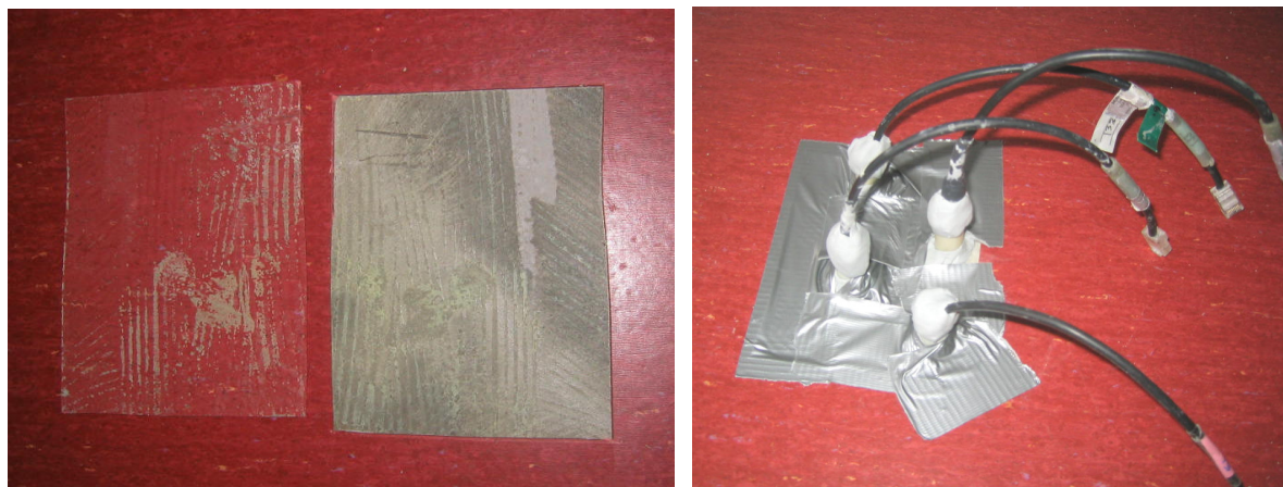
Kuva 3. Esimerkkinä porareikämittauspiste PR2. Vasemmalla lattianpäällysteestä irrotettu pala. Oikealla Vaisala Oy:n valmistamat HMP44-mittapääät ovat tiivistettyinä putkitettuihin mittausreikiin. Paljas lattiapinta suljettiin ilmastointiteipillä, jotta rakenteen pintaosa ei pääse kuivumaan merkittävästi mittausten aikana. Tällöin pintaosien mittausräilyistä saattaisi tulla todellista alhaisempia suhteellisen kosteuden mittaustuloksia.
