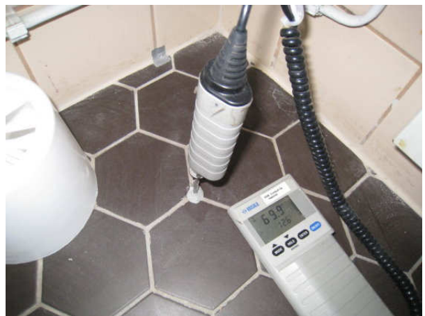
Kuva 6 Porareikämittaus PR3 lattiasta, (12,5 °C, 70 %RH, 7,7 g/ m 3 on kuiva).
