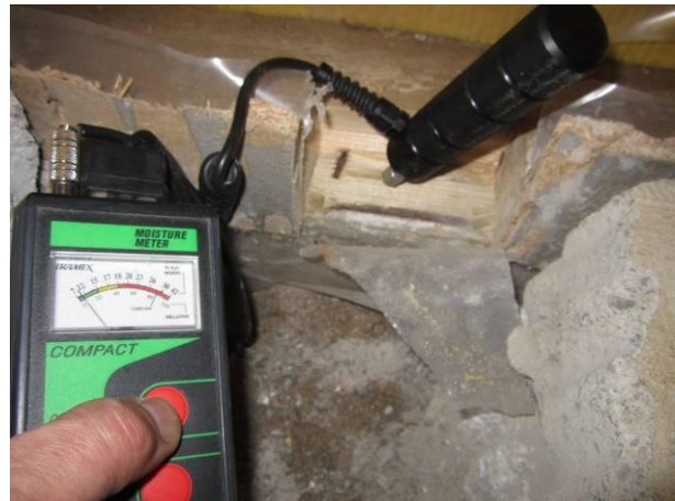
Kuva 28 Kestopuu on kuiva.
