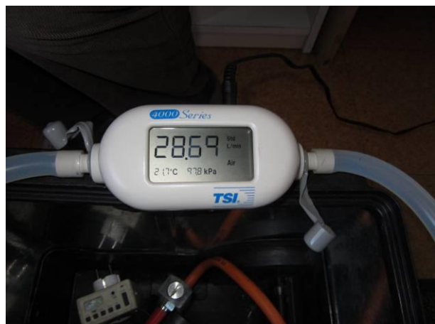
Kuva 21 Ilmavirtausmittarilla tarkistettiin ilmavirtaus jokaisen keräimen ja pumpun väliltä erikseen.
