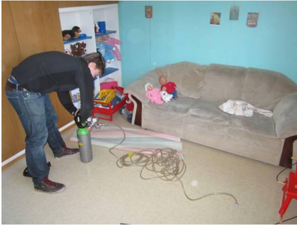
Kuva 15 Merkkikaasun annostelua alapohjaan poratun reiän läpi huoneessa 108.
