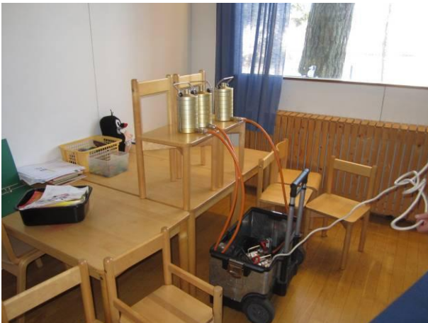
Kuva 17 Ilmanäytteiden otto huoneessa 108 kolmella erillisellä keräimellä.
