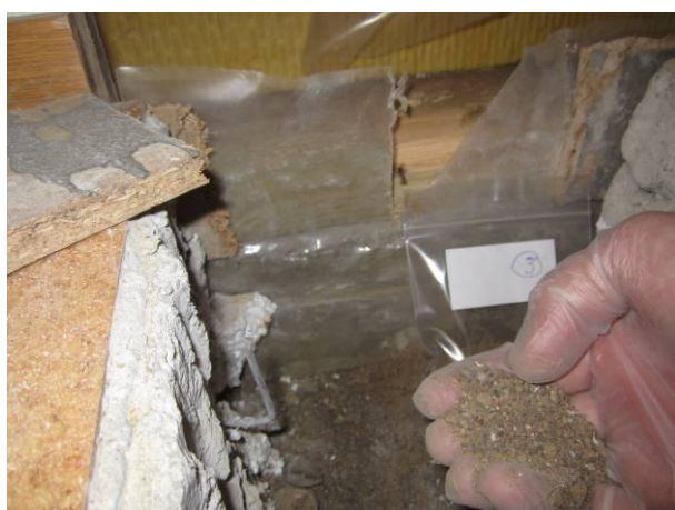
Kuva 29 AV3A kuivasta täyttöhiekasta otettiin mikrobinäyte MAT3.
