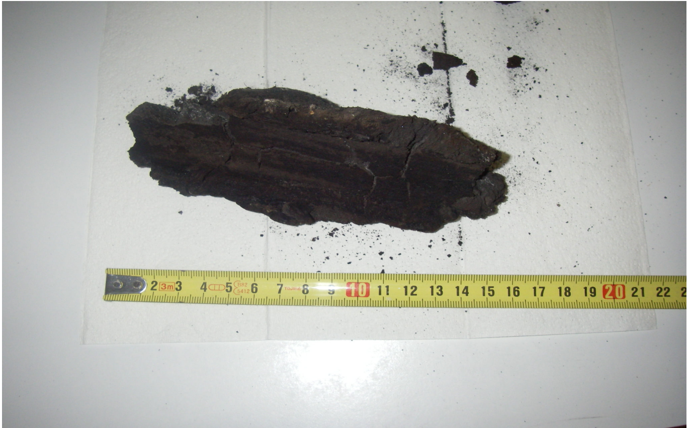
KUVA 29. Yleiskuva päärakennuksen tuloilmakanavasta poistetusta roskasta.
