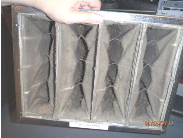
kuva 5 Kellaria palvelevan tuloilmakoneen raitisilmasuodatin. kuva 6 Alustatilan tuloilmakoneen raitisilmasuodatin on lähes tukossa.
