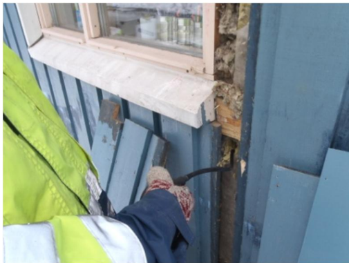
Kuva 15. Merkkisavukoe toimiston ikkunaliittymässä
