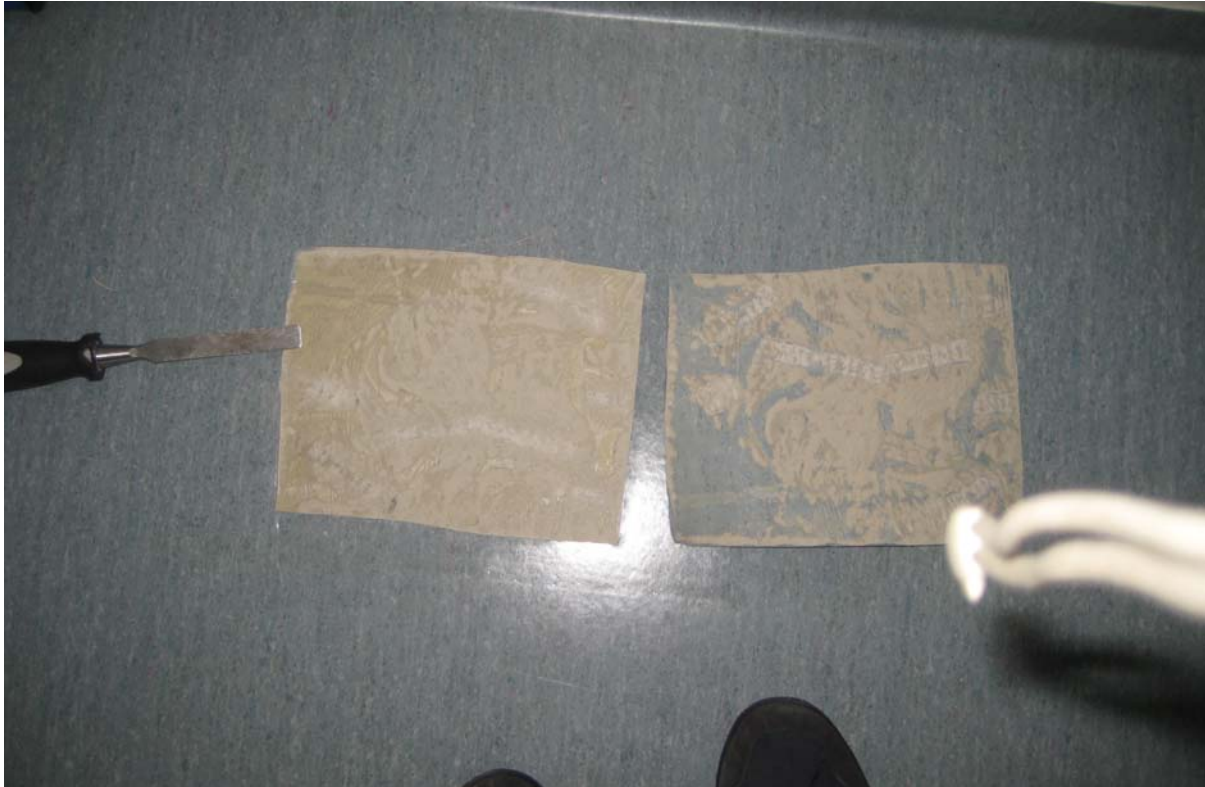
Kuva 3. Luokka 129B. Muovimatto oli kovaa kiinni lattiassa ja osa tasoitemateriaalista jäi näytteen kiinni. Muovimaton 2-etyyliheksanoliemissio oli silti verraten suuri.
