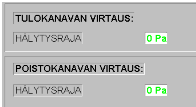
Kuva 9. TK2:n kanavapaineiden hälytysrajat ovat jostain syystä 0 Pa. Hälytysrajan olisi syytä olla isompi, jotta pyörimättömästä puhaltimesta tulisi hälytys. Vastaavia 0 Pa rajoja löytyy myös muista IV-koneista.
