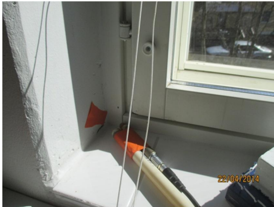
Kuvat 15a ja b. Kuvassa a on .merkkiainekoe, jossa havaittiin ulkoseinän eristetilaan syötetyn kaasun tulevan ikkunaliittymien kulmista. Kuvassa b on irrotettu ikkunaliittymän listoja, joiden alla vuotopaikoiksi havaittiin tiivistysnauhojen risteymät ja osin niiden reunaliittymät karmiin tai betoniseinään.
