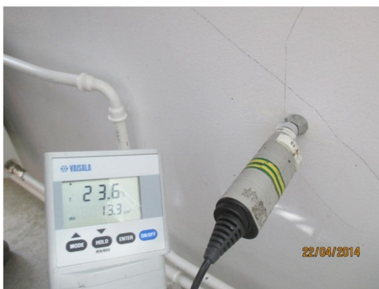
Kuvat 19a ja b. Kuvassa a on. ulkoseinän eristetilan kosteusmittaus 24.4.14 betoniseinän läpi eristeen keskialueelta, jolloin aurinko lämmitti julkisivua ja mahdollisesti aiheutti korkean vesihöyrysisällön. Kuvassa b on ulkoseinän eristetilan mittaus pilvipoudalla läheltä eristeen ulkopintaa.
