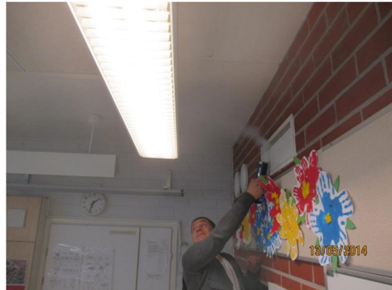
Kuvat 14a ja b. Kuvassa a on yleiskuva luokasta 236, jossa ilmanvaihtoelimet ovat käytävän puoleisessa tiiliseinässä. Kuvassa b on merkisavulaitteella tehty koe, joka osoitti tuloilman siirtyvän hyvin ikkunalle asti.
