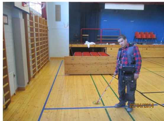
Kuvat 6a ja b. Kuvassa a on kosteusmittauspiste välinevaraston lattiaan. Kuvassa b on merkkiainekokeen perusteella vuotoa pylvään kiinnityspisteen tv. luukun kohdalta..
