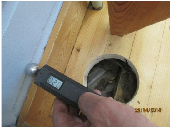
Kuvat 8a ja b. Kuvassa a on kuivaa rakennetta vastaava pintakosteusarvo. Kuvassa b on pölyä tuolivarastossa.
