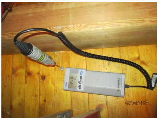
Kuvat 6a ja b. Kuvassa a on kosteusmittauspiste välinevaraston lattiaan. Kuvassa b on merkkiainekokeen perusteella vuotoa pylvään kiinnityspisteen tv. luukun kohdalta..
