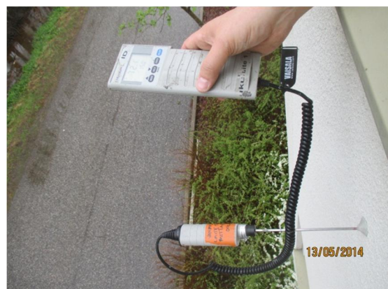
Kuvat 19a ja b. Kuvassa a on. ulkoseinän eristetilan kosteusmittaus 24.4.14 betoniseinän läpi eristeen keskialueelta, jolloin aurinko lämmitti julkisivua ja mahdollisesti aiheutti korkean vesihöyrysisällön. Kuvassa b on ulkoseinän eristetilan mittaus pilvipoudalla läheltä eristeen ulkopintaa.
