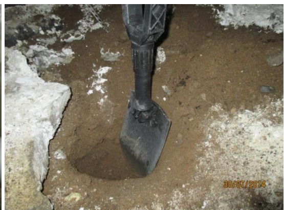
Kuvat 28a ja b. Kuvassa a on alaosaltaan märkä peruspalkki, jonka läpi on alustalohkojen välinen ilmanvaihtoreitti. Viemäri on tukematta pitkältä osuudelta. Kuvassa b on koekuoppa puutyösalin konehuoneen/ puuvaraston kohdalta. Hienoaineksia sisältävän sorapatjan paksuus on yli 20 cm.
