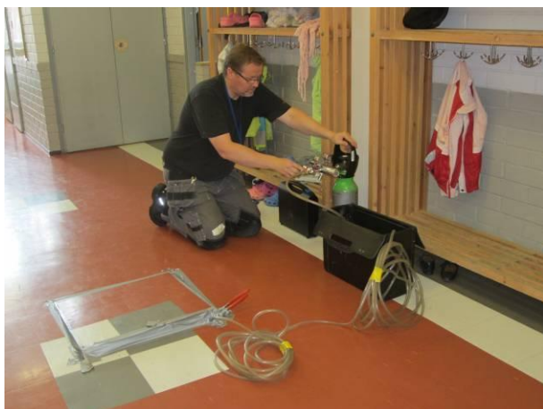
Kuva 47. Merkkikaasua laskettiin alustatilaan.
