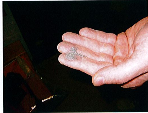
Kuva 2. Kanavan metallipurua ja -pölyä.
