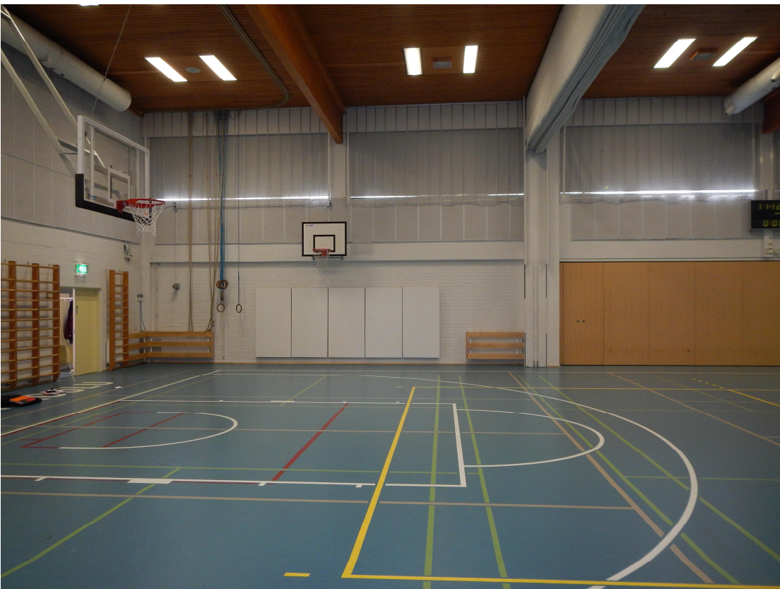
Kuva 6. Liikuntasali 1105. Lattianpinnoite Pulastic Pro 180 Comfort. Lattiarakenteesta mitattiin suhteellisen kosteuden arvoja välillä 80...90 %. Pintabetonilaatassa arvot olivat välillä 82...85 %. Eristetilan suhteellinen kosteus oli 80...86 %. Maatäytön suhteellinen kosteus oli 93 %.
