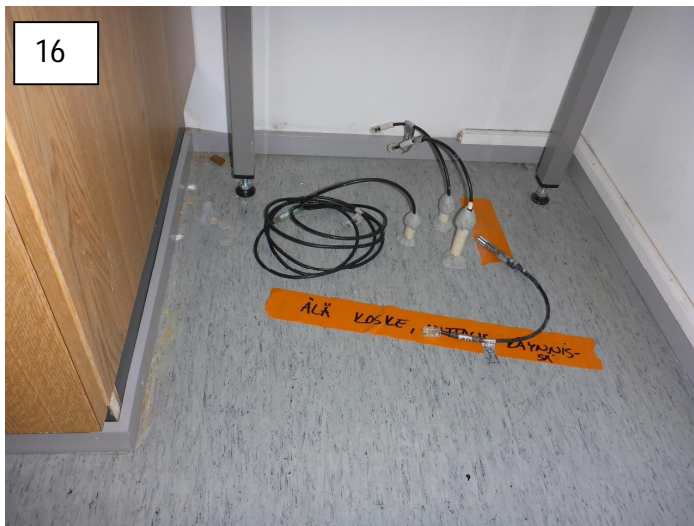
Kuvat 14 – 16. Esimerkit rakennekosteusmittausten viiltomittauksista (kuva 14), rakenteen lyhytkestoisesta suhteellisesta kosteudesta mittauksista (kuva 15) ja porareikämittauksista (kuva 16).
