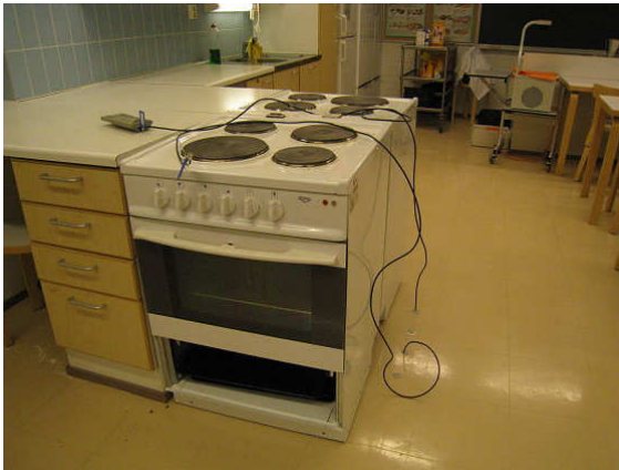
Kuva 3 MP5 (1-4). Porareikien 2 ja 4 kosteusmittaus meneillään.
