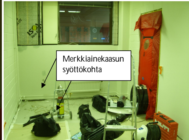
Kuva 1 (vasen). Huonetila 182 . Tiivistystyön jälkeen luokkahuoneessa havaittiin vain yksi (kuvaan merkitty) ilmavuotokohta.
