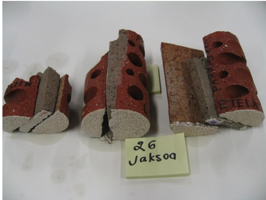
Kuva 16. Jäädytys - sulatuskäsittelyyn asetetut näytteet 26 jakson jälkeen. Näytteissä "Itä" (vasemmalla) ja "Etelä" (oikealla) laastin ja tiilen välinen tartunta on pettänyt kummastakin tiilestä. Näytteessä "Lounas" tartunta on pettänyt toisesta tiilestä. Oikeanpuoleisissa näytteissä kuultorappaus on irronnut laastin kohdalla.
