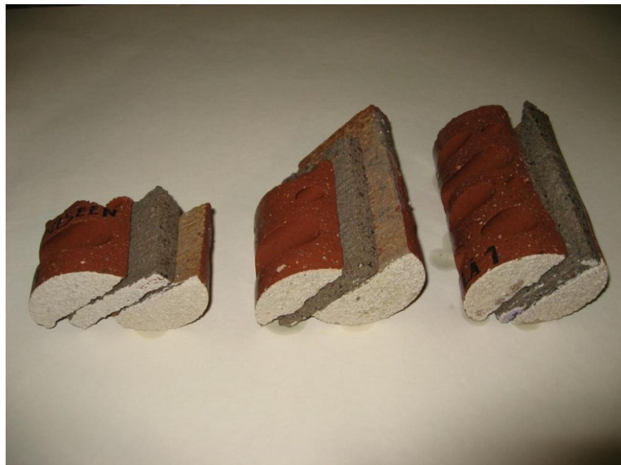
Kuva 17. Jäädytys - sulatuskäsittelyyn asetetut näytteet 49 jakson jälkeen. Kaikissa näytteissä laastin ja tiilen välinen tartunta on pettänyt. Oikeanpuoleisissa näytteissä kuultorappaus on irronnut varsinkin laastin kohdalla.
