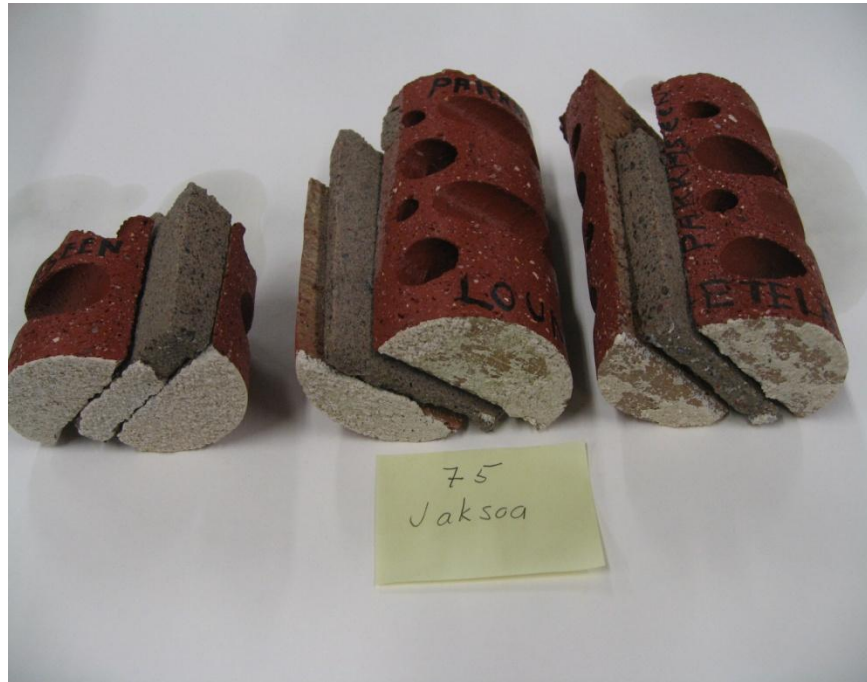
Kuva 18. Jäädytys - sulatuskäsittelyyn asetetut näytteet 75 jakson jälkeen. Oikeanpuoleisten näytteiden kuultorappaus on irronnut lähes kokonaan ja mukana hieman laastia. Vasemmanpuoleisen näytteen kuultorappaus on irronnut osittain laastin kohdalta
