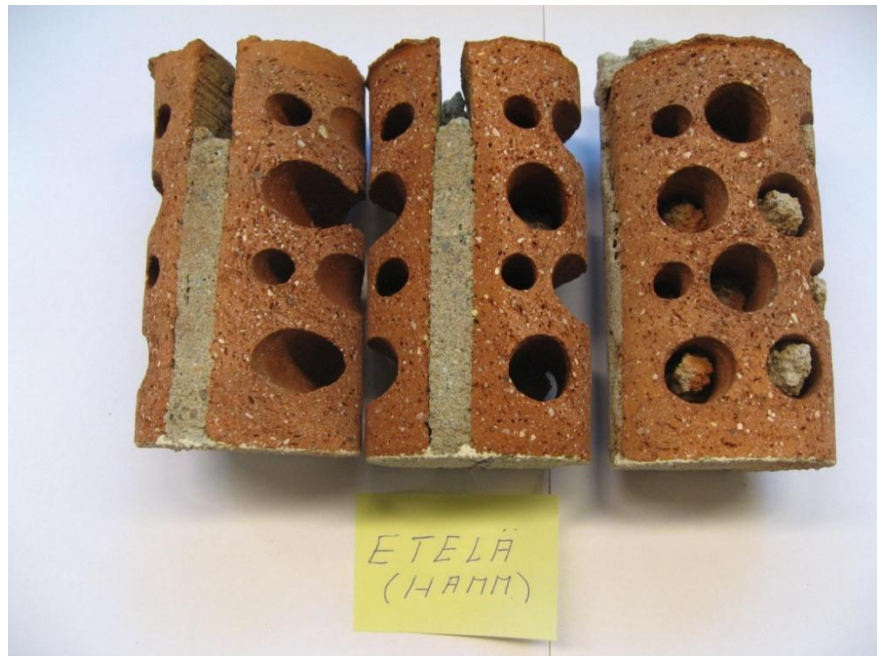
Kuva 7. Etelään avautuvasta julkisivusta (hammashoitolan yläpuolelta) poraamalla irrotetut näytteet. Näytteet on irrotettu ehjästä kohdasta läheltä vaurioitunutta kohtaa. Vasemman puoleinen näyte asetettiin jäädytys - sulatuskäsittelyyn, keskimmäisestä näytteestä tehtiin ohuthie ja laastianalyysi. Oikeanpuoleisesta näytteestä tehtiin ohuthie ja määritettiin laastin vetolujuus.
