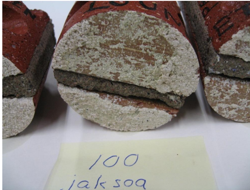
Kuva 20. Jäädytys - sulatuskäsittelyyn asetettu näyte "Lounas 1" 100 jakson jälkeen. Kuultorappauslaasti on irronnut laastin ja tiilen kohdalta lähes kokonaan ja mukana hieman laastia.
