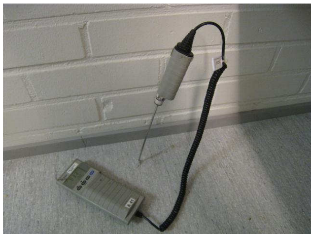
Kuva 5 Varasto/ tila 1.056 porareikämittaus PR10 osoittaa 83 %RH.
