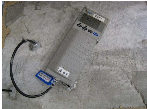
Kuva 4 PR2 -mittaus / mp1 osoittaa 92 %RH.
