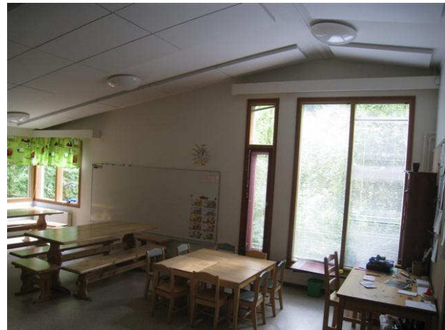
Kuva 72 Ryhmähuone 139, korkeista ikkunoista tulee lämpösäteilyä.
