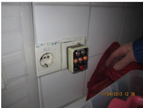
Kuva 5 Suko-testaus päiväkotitiloissa B-porras asunto 5:n keittiö.
