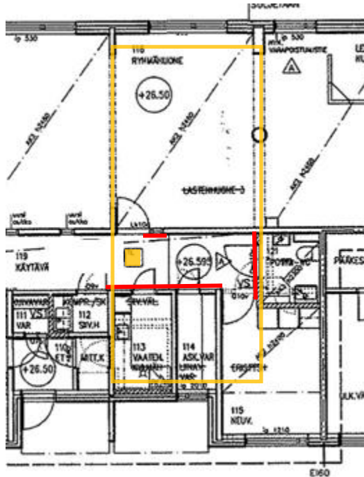
Kuva 2. Merkkiainetutkimus päiväkodin tuulettuvaan alapohjatilaan. Alapohjatila ja alapohjan kulkuluukku on rajattu kuvaan keltaisella. Ilmavuotoa alapohjatilasta huoneilmaan todettiin läheisistä seinälattialiitoksista (punaiset viivat).
