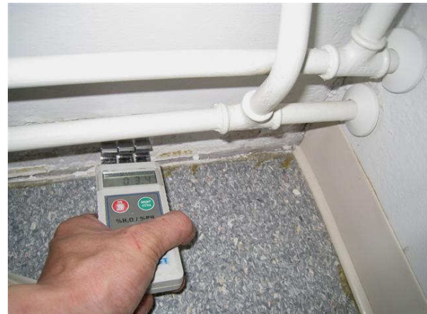
Kuva 24 Ulkoseinän lattiarajan muovilista oli irti var.118 kohdalla, pk-arvo koholla.
