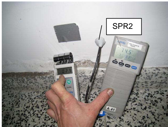
Kuva 3 Porareikämittaus SPR2, jossa lämpötila oli 18,4°C ja suht. kosteus 74 %RH. Maali ja tasoite ovat irti alareunassa.
