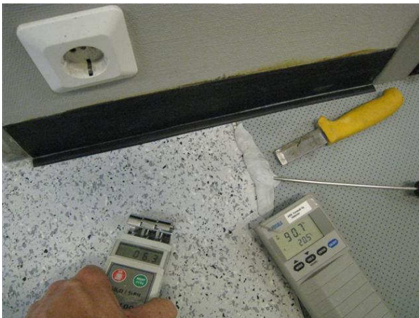
Kuva 21 Viiltomittaus ViiltoPR12 133/ vainajat kulmalla spk 132 kohdalla, maton alusta on hyvin kostea, 90 % RH, myös pintakosteusarvot olivat maksimiarvoja ao. asetuksella kirjavan maton alueella.
