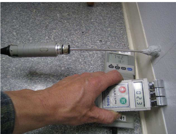
Kuva 11 Neuv./ var. 021 maanp. seinän mitatut arvot olivat/ SPR10 18,1 °C 74%RH, kosteus on koholla verrattuna SPR9.
