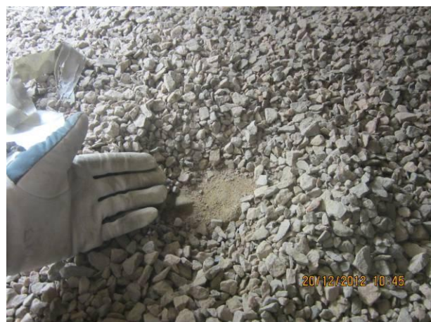
Kuva 20 Sepelikerros on ohut, alla on kova hiekkaa.
