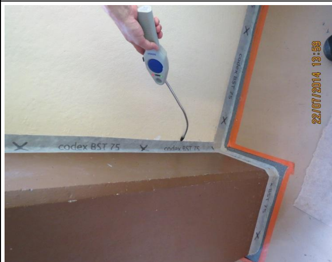
Kuva 6: vuotokohta, pilarin ja sisäkuoren liitos
