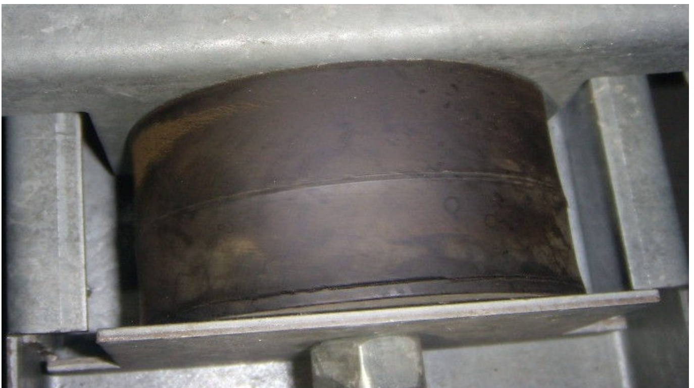
KUVA 4. Yleiskuva puhaltimen kumitynnystä.
