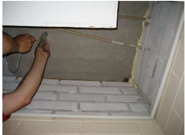
Kuva 8 Poikien wc-tilan kattoon tehtiin kipsilevyalakatton yläpuolelle porareikä PR8, jonka kohdalta otettiin mikrobinäyte sepelistä.
