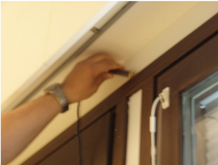
Kuva 6. Luokassa 070 oli yksi vuotokohta ikkunan yläpuolisen peitelistan takaa.
