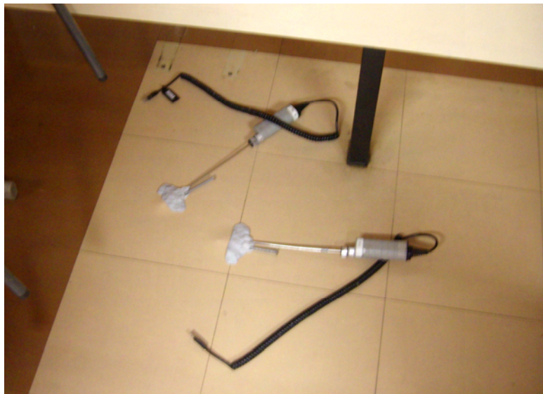
Kuva 6. Ruokalan lattiaan vinylilaatan keskelle ja saumaan tehtyt mittapisteen V1 ja V2.
