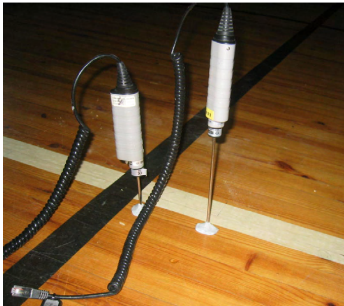
Kuva 8. Liikuntasalin lattian suhteellista kosteutta mitattiin lautalattian alta kahdelta syvyydeltä.
